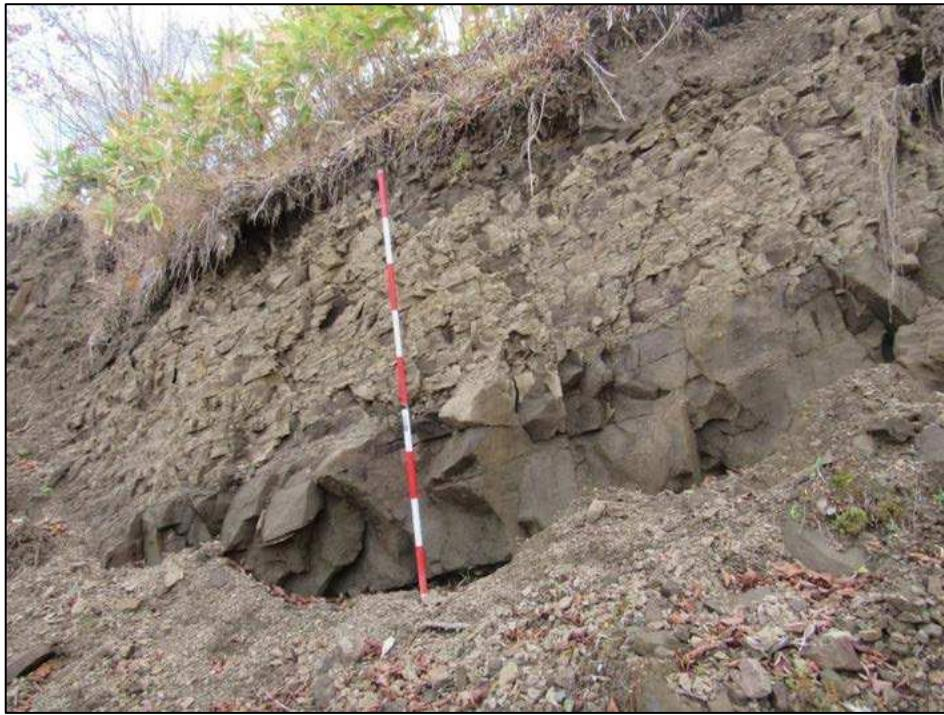
図5 岩盤は新第三系振迫層の砂岩・泥岩互層(N20° E・18° ESE、N8° E・24° Eで流れ盤)
