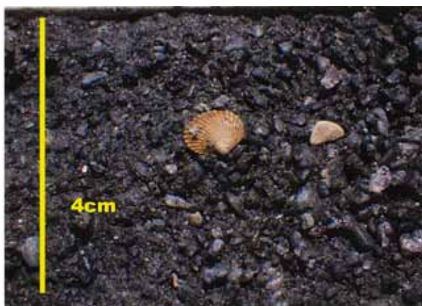
第6図 北進橋KHB-4孔コア(柱状図示さず)の深度13.5 m付近の砂礫と含貝化石。貝化石は北海道教育大学鈴木明彦教授によれば浅海に棲む寒流系のマルフミガイ類( Cyclocardia sp. )
