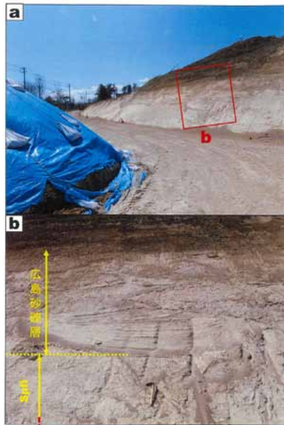
第10図 ボールパークアムピシャス通り（北広島市総合体育館北西側）の切土露頭写真. a: 露頭全景, b: 写真aのb地点の部分拡大写真（支笏火山噴出物 Spfl の上位に広島砂礫層が重なる）.
