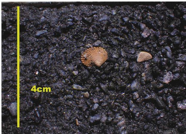
第6図 北進橋KHB-4孔コア(柱状図示さず)の深度13.5 m付近の砂礫と含貝化石。貝化石は北海道教育大学鈴木明彦教授によれば浅海に棲む寒流系のマルフミガイ類(*Cyclocardia sp.*)
